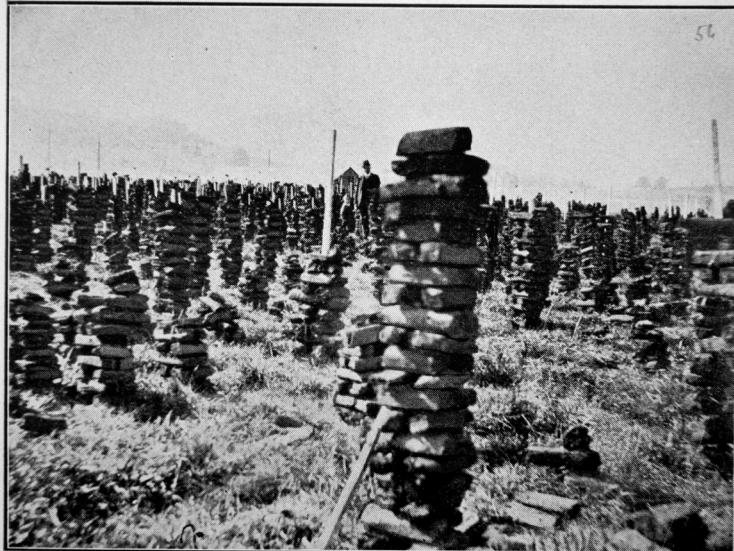
Aufgestöckelter Maschinentorf auf Torffield Eschlikon (Thurgau) der S. T. G.
